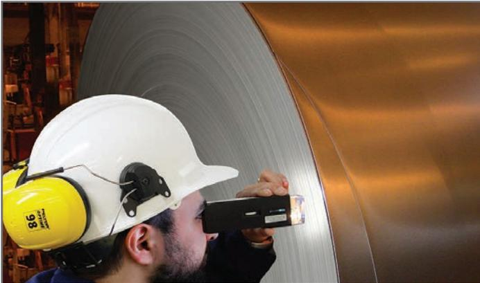
Alte Methode zur Prüfung der Besäumqualität erst nach Fertigstellung des Coils
