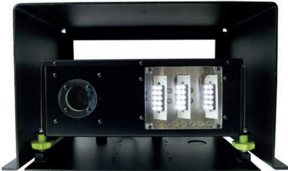
Das Kameragehäuse ist auf einer höhenverstellbaren Halterung montiert, um eine optimale Höhe zur Bandkante zu erreichen, und ist durch einen Schutzrahmen gegen mechanische Beschädigungen durch Schilfer (Bandabschnitt) geschützt.
