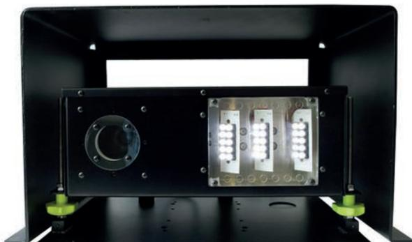
Le boîtier de la caméra est monté sur un support réglable en hauteur pour obtenir un niveau de bord optimal et protégé par un écran métallique contre les dommages mécaniques causés par les longerons.
